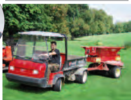
Zugfahrzeug mit Top-Dresser Toro Workman HDX /ProPass
